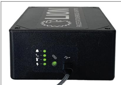
ABBILDUNG 1: STATUSANZEIGEN DES NETZWERKBRÜCKENADAPTERS
