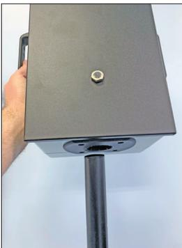
ABBILDUNG 2: PLATZIEREN DES TRÄGERKASTENS AUF DAS STATIV
