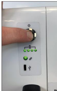
ABBILDUNG 6: TRÄGER ANGESCHLOSSEN UND ANZEIGE DER VOLLEN LEISTUNG
